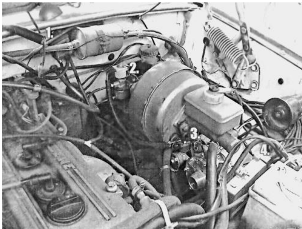
Рис. 40. Инжекторный двигатель ГАЗ-3110: 1 – датчик давления газа; 2 – электромагнитный газовый клапан; 3 – редуктор-испаритель; 4 – ЭБУ газа.
