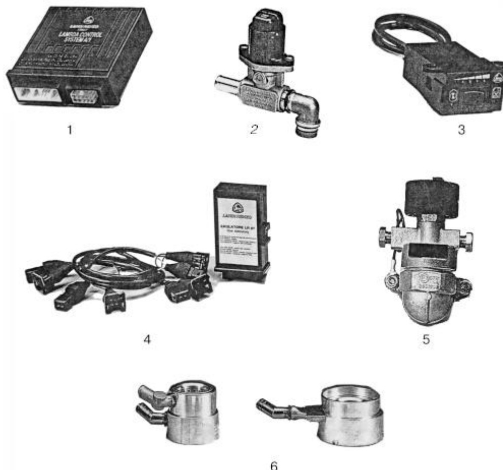
Рис. 45. Основные элементы системы «Landi Renzo»: 1 – электронный блок управления LCS – A/1; 2 – электрический дозатор газа; 3 – двухпозиционный переключатель вида топлива с указанием уровня газа в баллоне; 4 – эмулятор форсунок с соединительным кабелем; 5 – газовый электромагнитный клапан; 6 – газосмесительное устройство для приготовления топливоздушнoй смеси.
