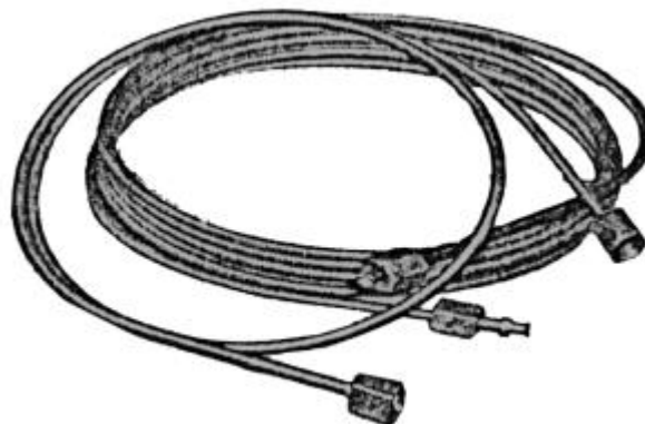
Рис. 7. Трубопроводы из нержавеющей стали.
